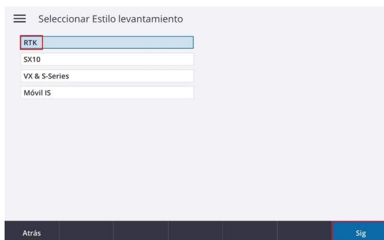
Sí en el estilo de levantamiento, habíamos indicado trabajar con un punto de montaje específico, el software directamente conectará con el servidor de correcciones y recibirá las correcciones de dicho punto de montaje y calculará nuestra posición de forma exacta.
